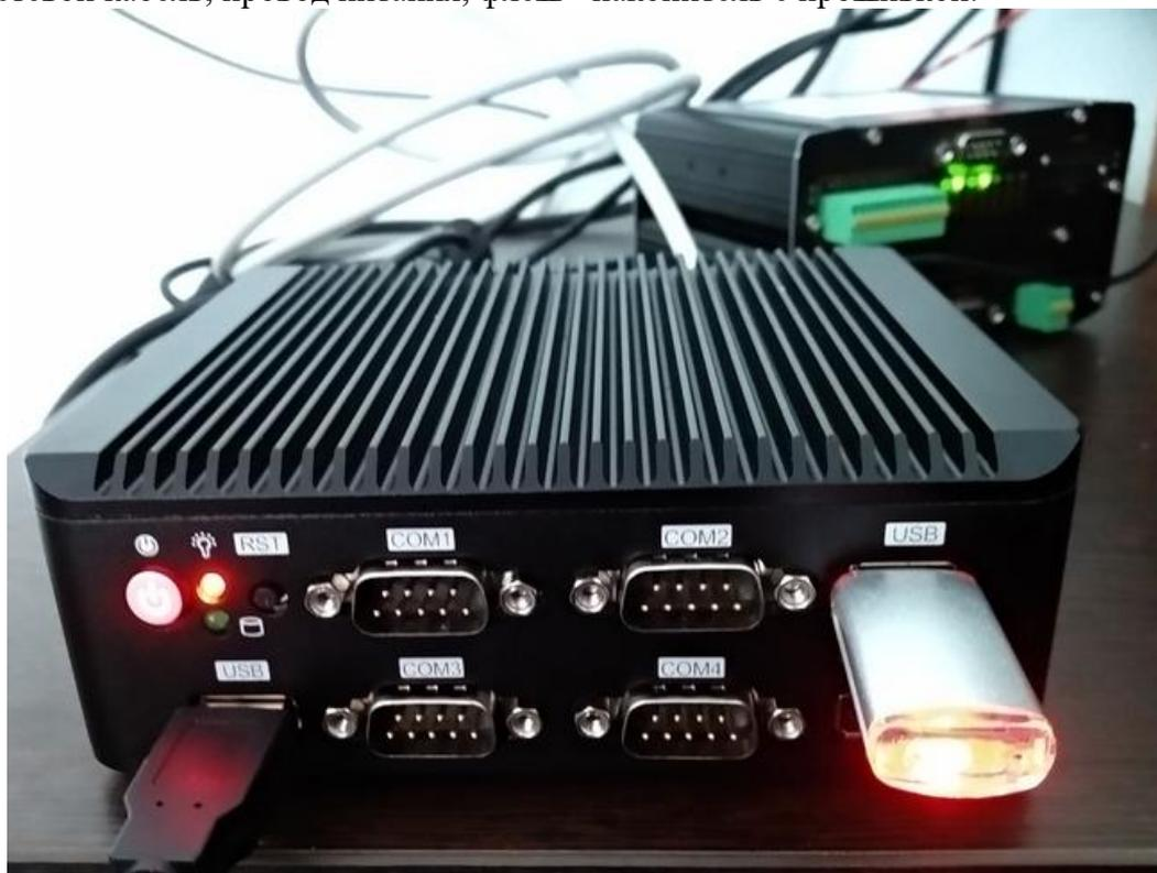
Рисунок 18 Общий вид одноплатного компьютера
