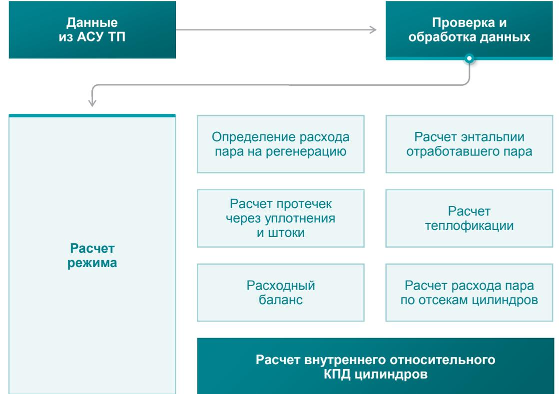
Результатом моделирования является получение объективной информации о техническом состоянии проточной части цилиндров, контроль снижения экономичности паровой турбины в процессе эксплуатации
