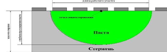
Схема распределения полупроводящей пасты.
